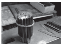
電気炉に入れるためにヤスリを束にする
