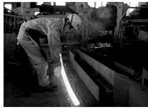
ひし形(両刃ヤスリ断面形状)の棒材にする
