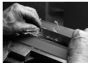
小刃(ヤスリ両端のエッジ部)を削る
